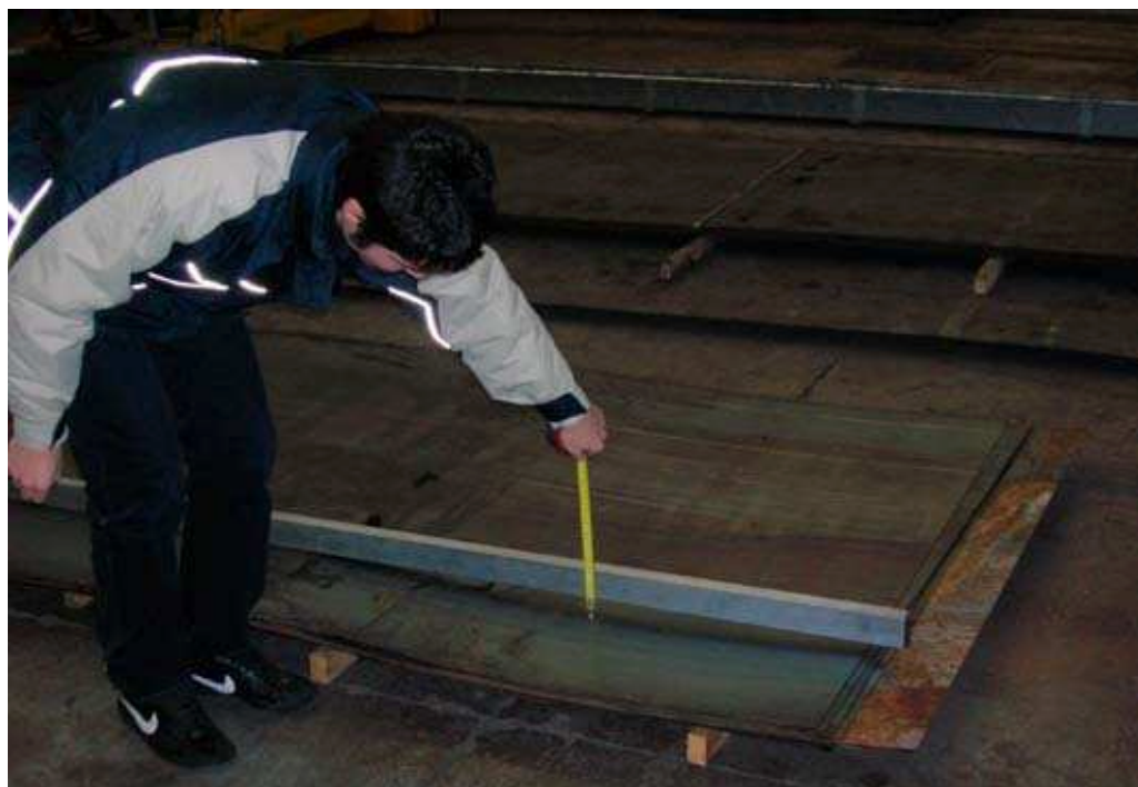
Metodologia scorretta per la misura della freccia
